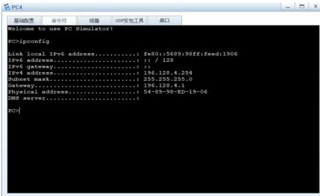
图 5.4 PC4 获取 IP 测试
